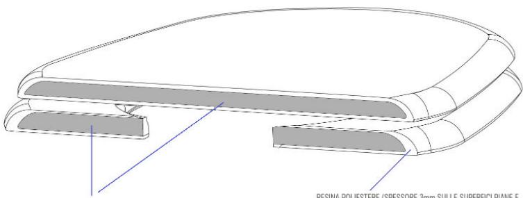
NUCLEO IN LEGNO TRUCIOLARE (SPESORE 14mm)
